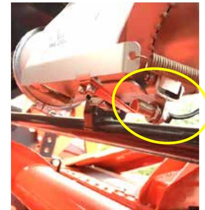
Alarma de la posición de la trampilla de prueba de dosis
