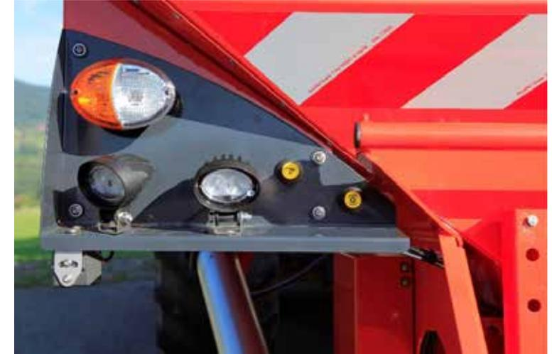
ÿ Para facilitar los ajustes y el llenado: iluminación de la tolva y del dosificador con LED
